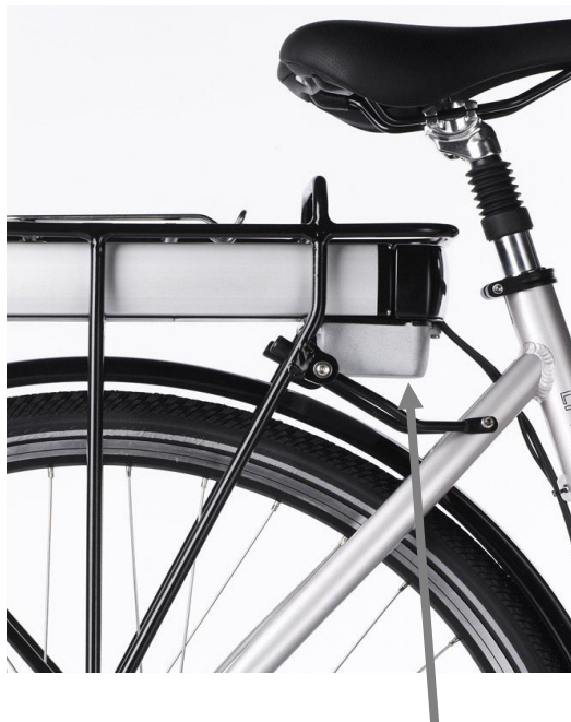
Placering af lysdiode under controller
